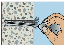
Rengjøring av borehull
