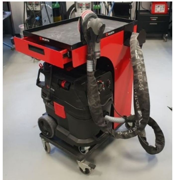
Slipevogn rigget med Würth støvsuger med autostart for elektrisk slipemaskin. Med hastighets- / støyregulering
