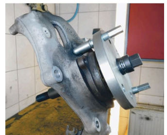
Demontering av hjullager
