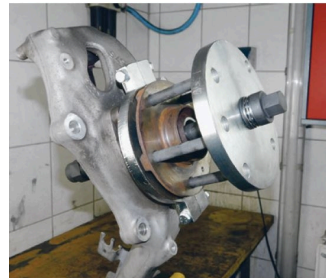
Demontering av hjulnav / spindel (Hub)
