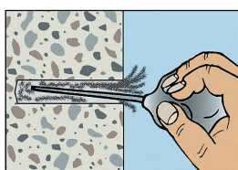
Rengjøring av borehull
